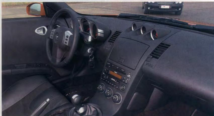
*Sur la Nissan Z, le bloc d'instruments est solidaire de la colonne de direction.*
