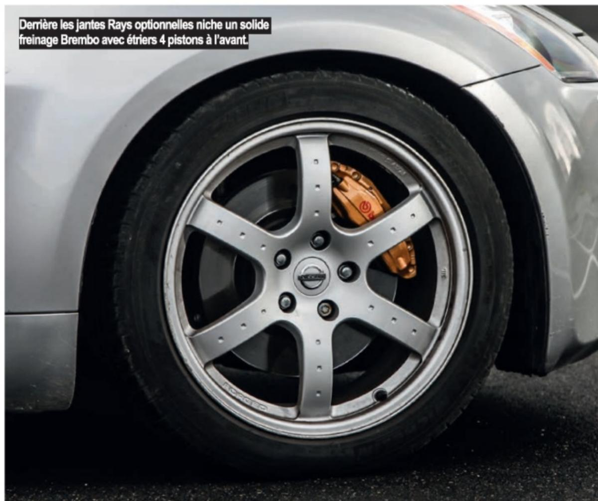
Dernière les jantes Rays optionnelles niche un solide freinage Brembo avec étriers 4 pistons à l'avant.
