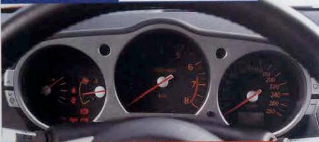
Le bloc à instruments est solidaire de la colonne de direction et bouge avec elle lorsqu'on l'ajuste en inclinaison.
