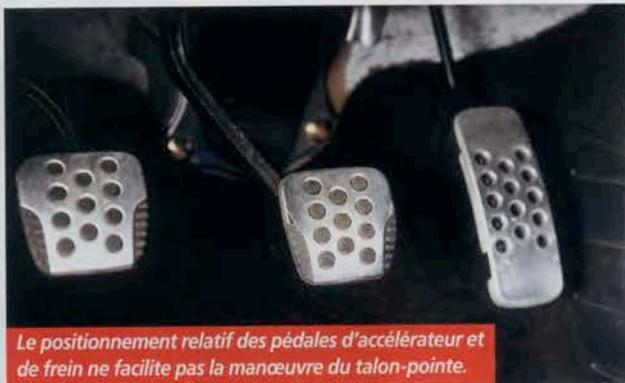
Le positionnement relatif des pédales d'accélérateur et de frein ne facilite pas la manœuvre du talon-pointe.
