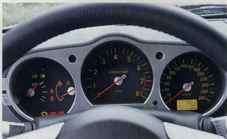
Pour faciliter sa visibilité, le combiné général est solidaire de la colonne de direction et se déplace avec le volant lors du réglage en hauteur ou en profondeur de ce dernier.
