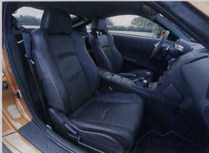
Le positionnement bas des sièges permet de recevoir des informations « en direct » sur les réactions du châssis. Faisant preuve d'une fermeté convenable, le petit levier de vitesses pâtit d'une course transversale trop importante qui ralentit son maniement.
